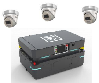
天井カメラによる広域誘導
